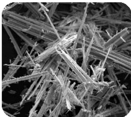
Ingrandimento al microscopio delle fibre di amianto
